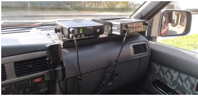
Interior del móvil se agregó una radio base VHF
